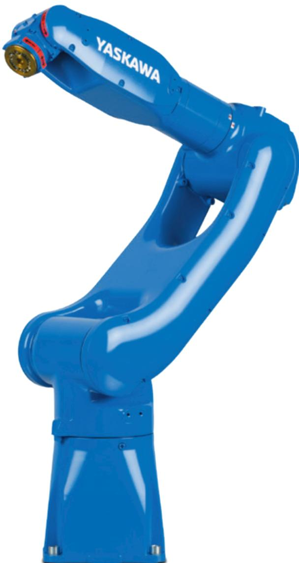
Der MOTOMAN GP7 ist ein extrem schneller und präziser 6-achsiger Industrieroboter mit einer Traglast von bis zu 7 kg. Mit einer Reichweite von 927 mm und einer hohen Wiederholgenauigkeit von  $\pm 0,01$  mm ist er für Montage-Aufgaben bestens geeignet, aber auch für universelle Handling-Aufgaben, CNC-Werkzeugmaschinenbeladung oder Verpackung. Sein modernes, glattes und schlankes Industriedesign gefällt und minimiert den Platzbedarf am Einbauort.
