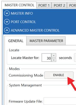
Im Normalbetrieb (*Commissioning Mode* deaktiviert) hat der IO-Link Manager keinen schreibenden Zugriff auf die Prozessdaten eines IO-Link Device. Damit Sie vom IO-Link Manager Prozessdaten an ein IO-Link Device ausgeben können, müssen Sie für den entsprechenden IO-Link Master den "*Commissioning Mode*" aktivieren.
