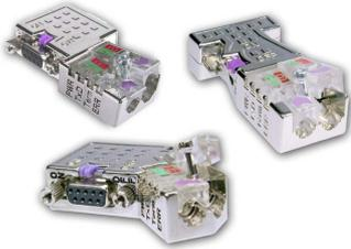
In PROFIBUS werden alle Teilnehmer parallel verdrahtet. Hierzu ist das Buskabel durchzuschleifen. Unter der Best.-Nr. 972-0DP10 erhalten Sie von VIPA den Stecker "EasyConn". Dies ist ein Busanschlussstecker mit zuschaltbarem Abschlusswiderstand und integrierter Busdiagnose.
