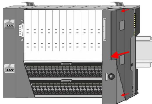
1. ➤ Entfernen Sie vor der Montage der Peripherie-Module die Bus-Blende auf der rechten Seite der CPU, indem Sie diese nach vorn abziehen. Bewahren Sie die Blende für spätere Montage auf.
